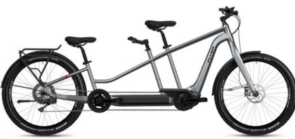
„G3 Tandem 7.70“ von Flyer Ein Highlight des E-Tandems ist der wartungsarme Carbonriemen, der die beiden Kurbeln verbindet. Ansonsten punktet das Rad durch einen Bosch-Motor sowie eine Doppel-Akku-Lösung mit 1250 Wattstunden. So sind auch längere Touren möglich. UVP: 8.749 Euro
