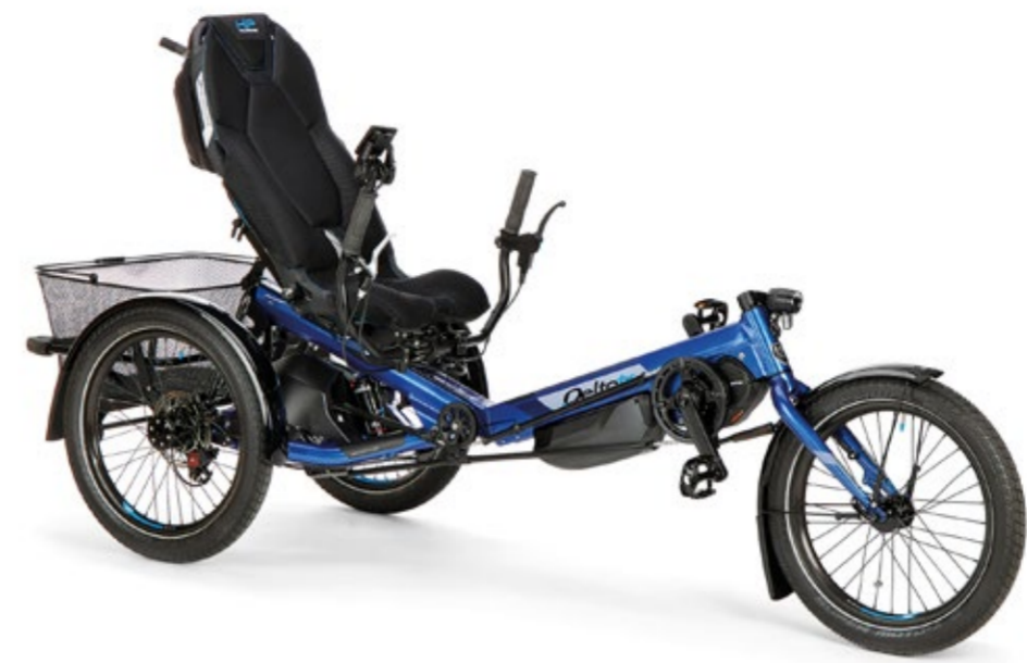
„Delta tx“ von HP Velotechnik Ein kippstabiles, komfortables E-Trike, das aber auch äußerst sportlich ist. In der Ausführung mit Untenlenker wird ein einfaches Auf- und Absteigen ermöglicht. Motor und Schaltung sind individuell, an den gewünschten Fahrstil angepasst. UVP: ab 6.949 Euro
